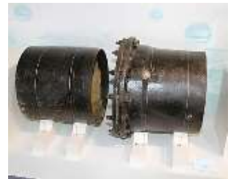
阪神大震災で裂けた水道管
